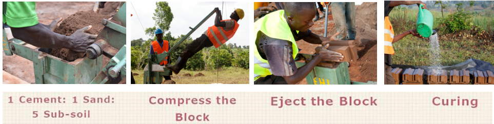
Figure 16. Procédé de fabrication des blocs ISSB © Nambatya, Mauricia. 8-12 avril 2024.
