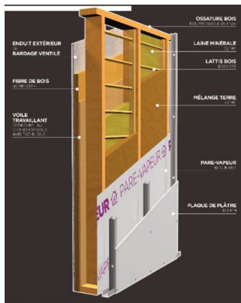
Figure 18. Principe du procédé Terlian® et configuration de mur en maison ossature bois © Hardy, Anne, 2024.
